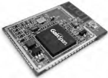
◻ 그림 A1-2 : GainSpan GS1011M 저전력 Wi-Fi 모듈<sup>61</sup>
