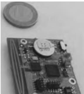
: 그림 5-14 : 자율 센서 전자 부품<sup>50</sup>
